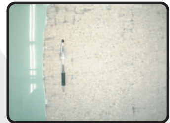
6Pカッターブレード使用
